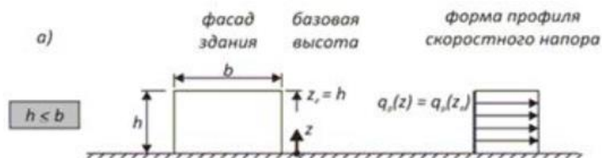
Рисунок А.2 – Базовая высота z_e в зависимости от h и b и профиля скоростного напора
